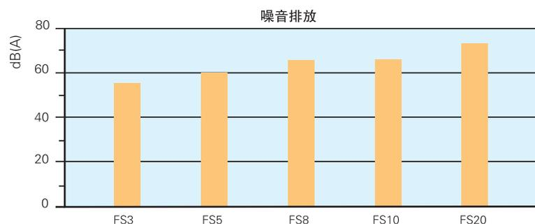
排放数据在各种型号最大输出条件下测量，符合EN676标准。
